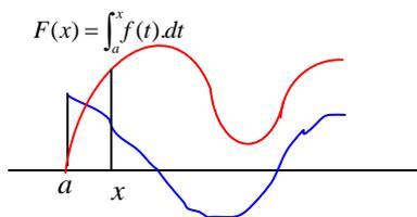
Dada la función  $f$ , continua en  $[a, b]$ , a partir de ella podríamos considerar la función  $F(x) = \int_a^x f(t) \cdot dt$  que nos da el área contenida bajo la función  $f$  entre "a", un punto variable  $x$  y el eje  $OX$ .
