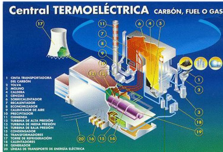
**Central termoeléctrica:** instalación empleada para la generación de energía eléctrica a partir de la energía liberada en forma de calor, normalmente mediante la combustión de algún combustible fósil como petróleo, gas natural o carbón. Este calor es empleado por un ciclo termodinámico convencional para mover un alternador y producir energía eléctrica. Por otro lado, también existen centrales termoeléctricas que emplean fisión nuclear del uranio para producir
